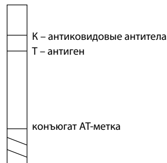
Рис. 6. Принцип устройства тест-полоски для обнаружения наркотических средств и психотропных веществ
