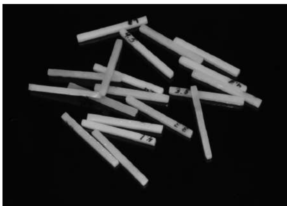
Рис. 2. Готовые образцы композитов для проведения исследования прочности на изгиб Fig. 2. Ready-made samples of composites for the study of bending strength
