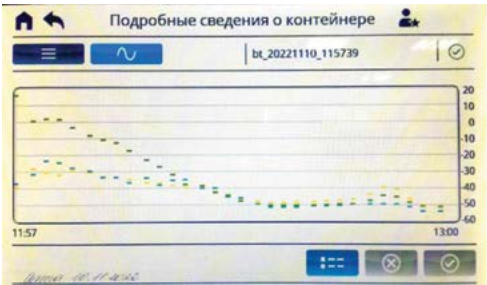
Рис. 5. Данные измерения температуры внутри контрольного контейнера для плазмы объемами 0,600 л во 2-й загрузке Fig. 5. Temperature measurement data inside a test container for 0.600 l of plasma in 2 load
