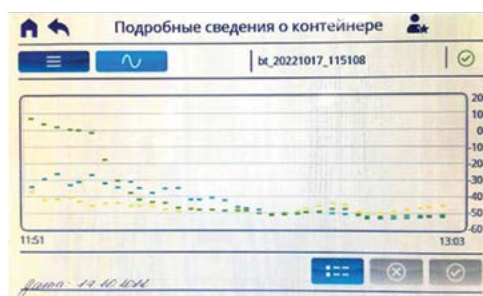
Рис. 1. Данные измерения температуры внутри контрольного контейнера для плазмы объемами не более 0,300 л в 1-й загрузке Fig. 1. Temperature measurement data inside the test container for plasma in volumes not exceeding 0.300 liters in 1 load
