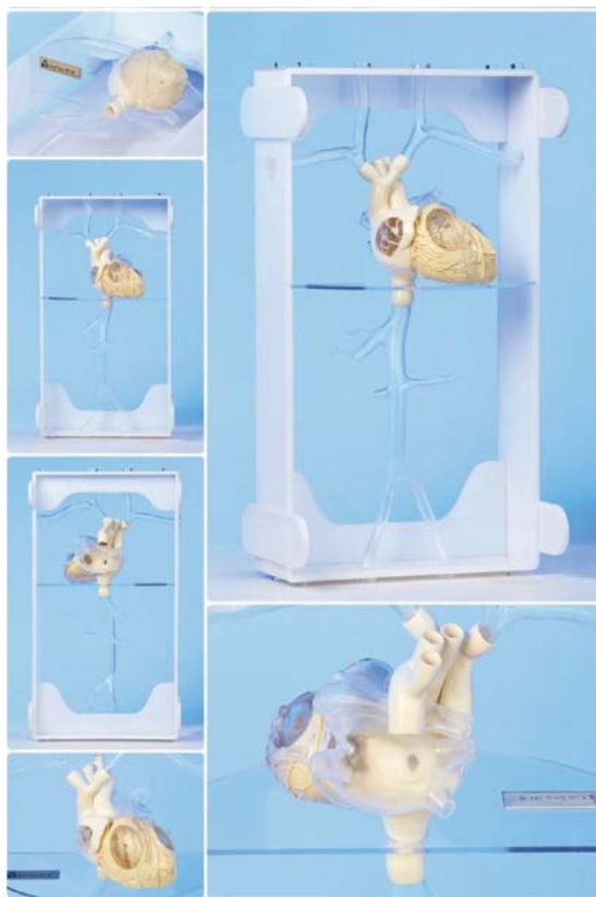
Рис. 3. Симулятор сердца и магистральных венозных сосудов человека Fig. 3. Human heart and main veins simulator
