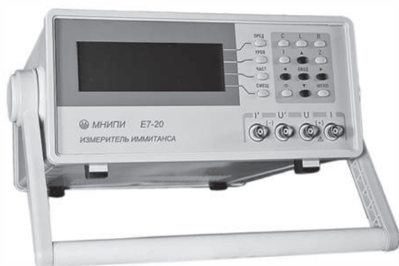
Рис. 1. Прибор, используемый в исследовании для измерения импеданса грудной клетки (производитель – Минский научно-исследовательский приборостроительный институт) Fig. 1. Instrument used in the study to measure chest impedance (manufactured by Minsk Research Instrument-Making Institute)
