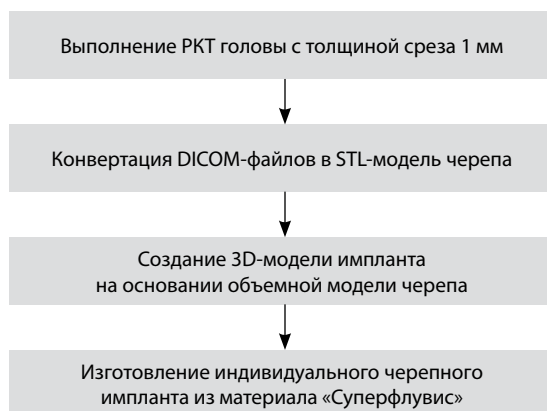
Рис. 1. Алгоритм создания индивидуального импланта из материала «Суперфлувис» Fig. 1. Algorithm for creating an individual implant with "Superfluvis" material
