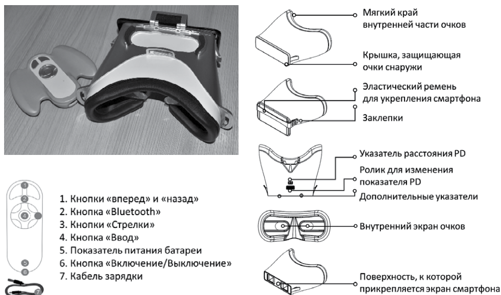
Рис. 1. Внешний вид (слева) и конструкция устройства Fig. 1. Appearance (left) and design of the device
