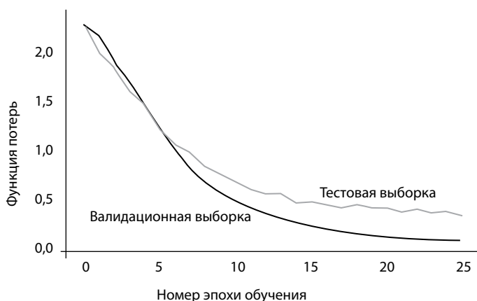
График изменения функции потерь при обучении СНС Graph of changes in the loss function during CNN training
